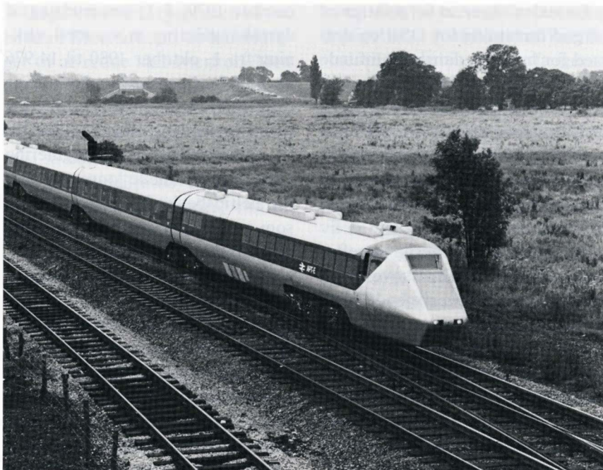
Kombineret elektro-hydraulisk krævningsudstyr og luftaffjedring gør det muligt for føreren at entre ikke-opbyggede kurver med store hastigheder. Proto(gasturbine)modellen på billedet satte strækningsrekord: 240 km/t.
